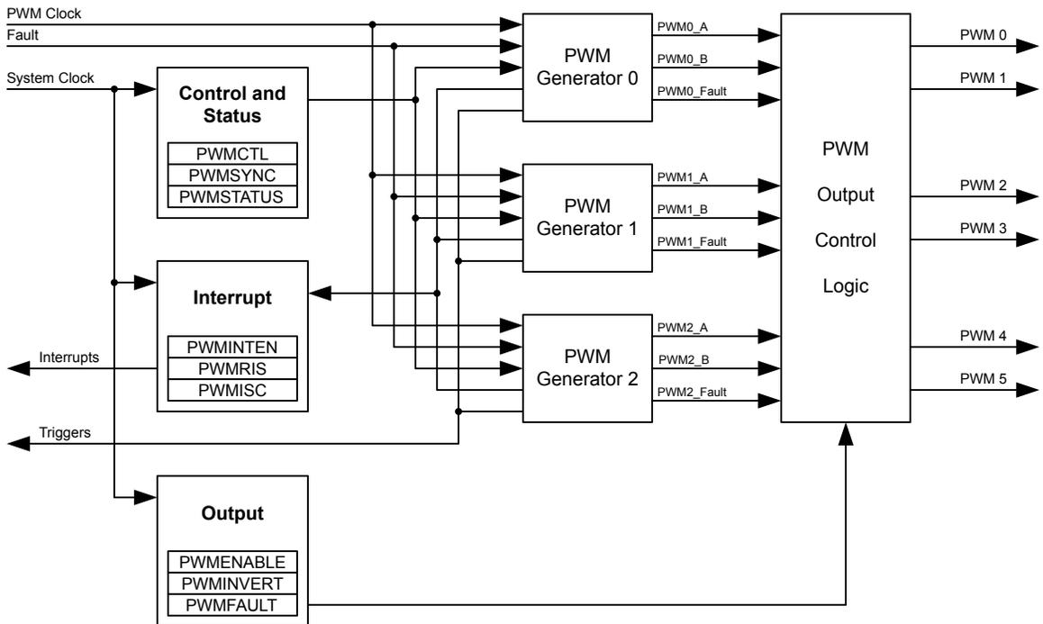
Figure 16-2. PWM Module Block Diagram
