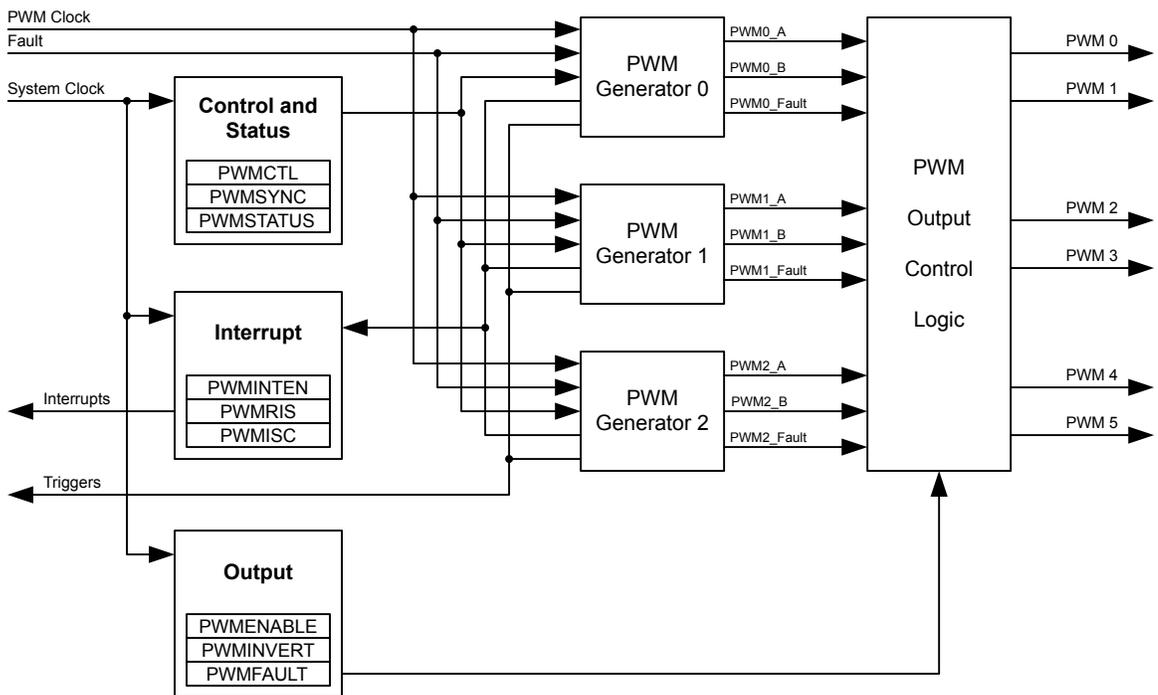
Figure 18-2. PWM Module Block Diagram
