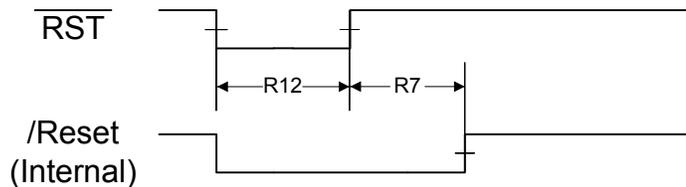
Figure 26-5. Power-On Reset Timing
