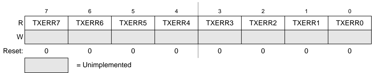
Figure 9-16. MSCAN Transmit Error Counter (CANTXERR)
