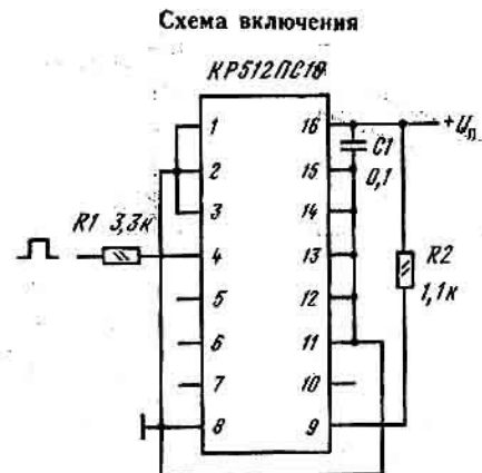
Типовая схема включения микросхемы КР512ПС10
