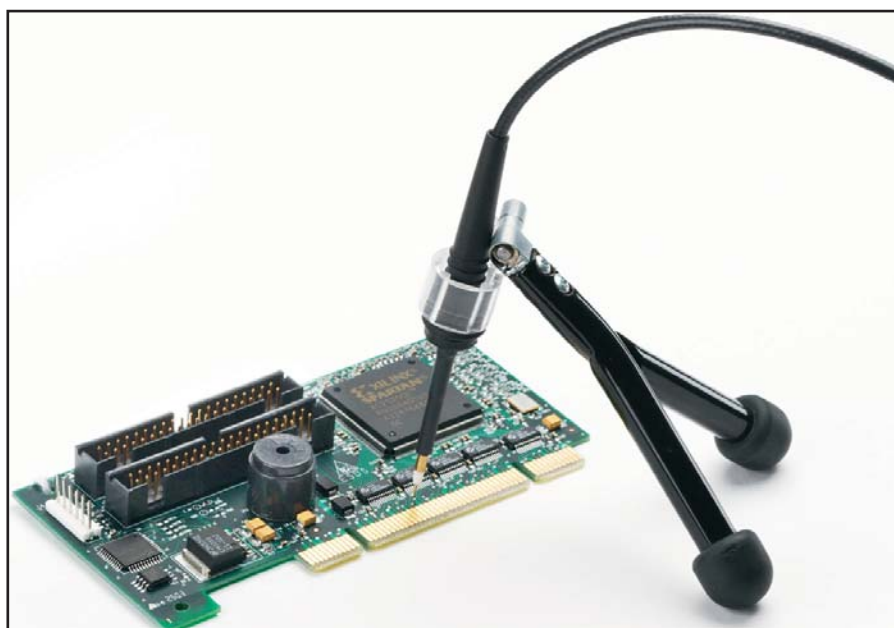
HFP пробник с оригинальным фиксатором "свободные руки"
