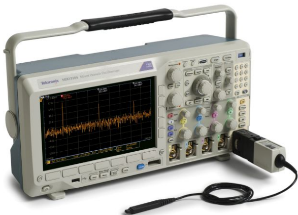
С помощью опционального адаптера TPA-N-VPI любой активный пробник TekVPI с входным сопротивлением 50 Ом может быть подсоединен к РЧ входу.
