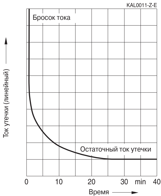
Рис. 15. Зависимость тока утечки от времени, в течение которого приложено напряжение
