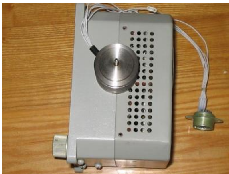
Фото 2 – Электродвигатель ДШИ-5 с коммутатором К-38У
