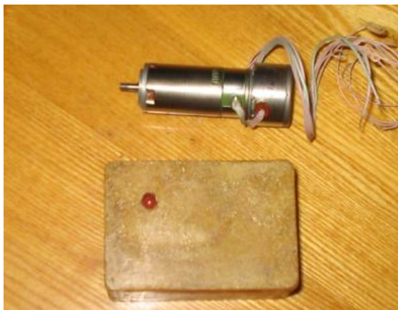
Фото 1 – Электродвигатель ДПР-32-Н6-02 с регулятором скорости РС-0-08-03М
